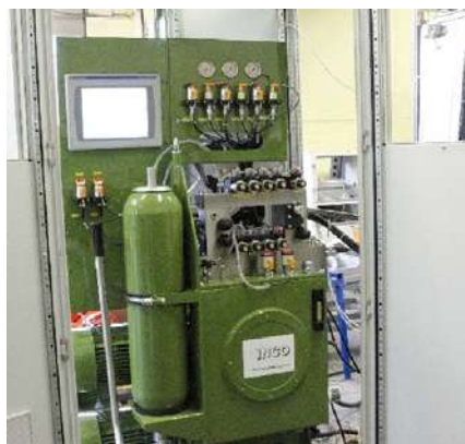
Электрогидравлическая тормозная система REPRIMATIC
