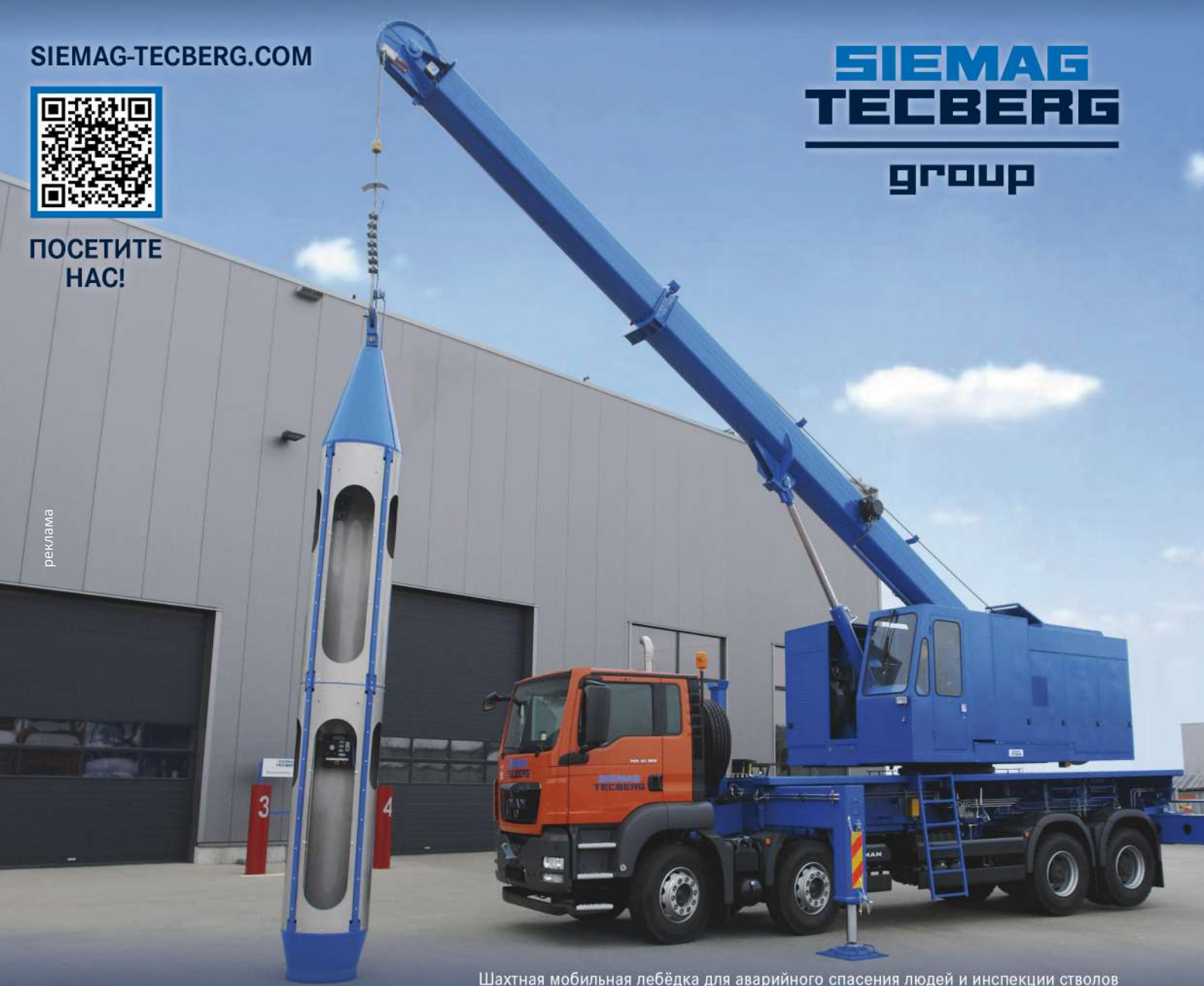
Шахтная мобильная лебёдка для аварийного спасения людей и инспекции стволов
