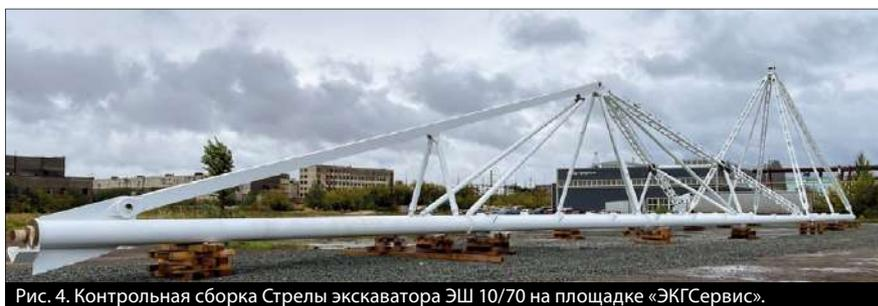
Рис. 4. Контрольная сборка Стрелы экскаватора ЭШ 10/70 на площадке «ЭКГСервис».
