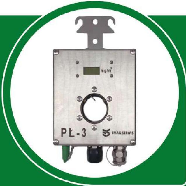
Пылемеры PL-3 предназначены для измерений массовой концентрации пыли различного происхождения с целью контроля пылевзрывобезопасности в шахтах и рудниках, опасных по газу и пыли.
