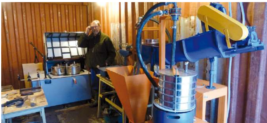
Рисунок 15. Установка для извлечения мелкого золота производительностью 22 кг/час на базе планетарной мельницы периодического действия МПП-2-1К.
