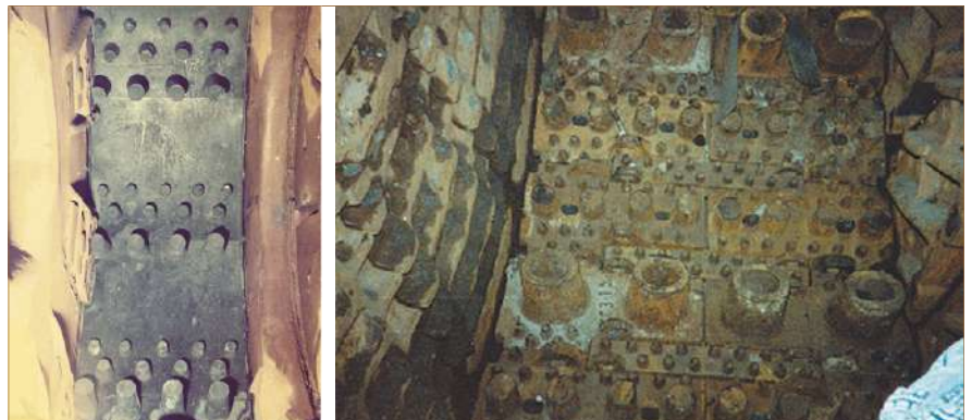
Рисунок 3. Испытание каблучковой футеровки на опытной мельнице D \times L = 2,1 \times 0,7 м (АК «АЛРОСА») и на цементном заводе на мельнице D \times L = 7,0 \times 2,3 м.
