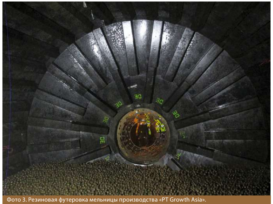
Фото 3. Резиновая футеровка мельницы производства «PT Growth Asia».
