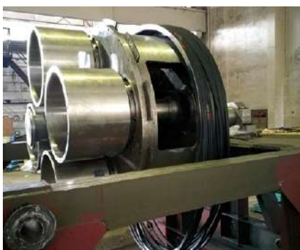
Рисунок 13. Планетарная мельница МП-3М.
