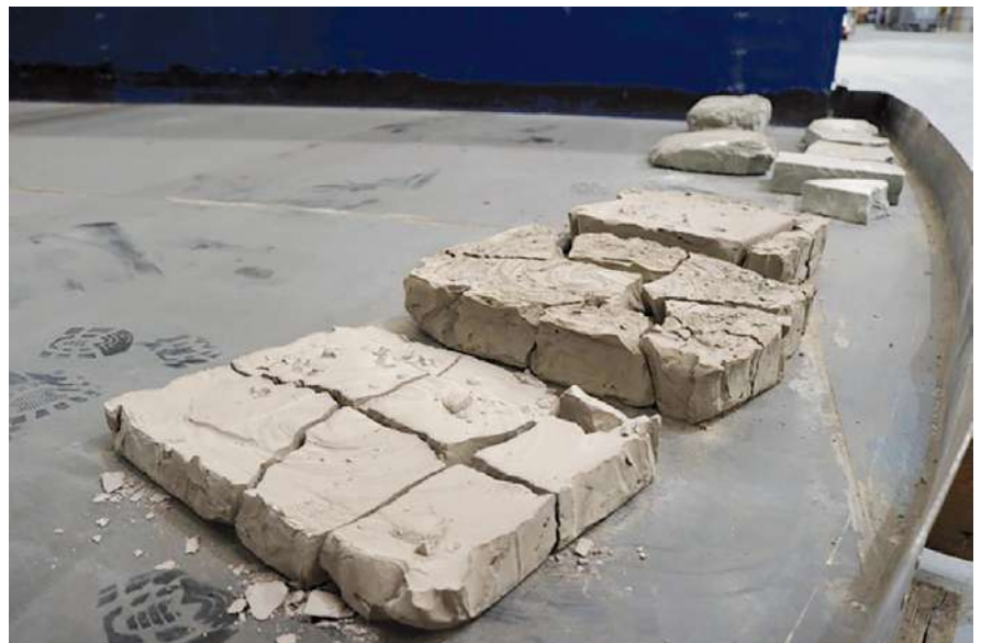
Процесс обезвоживания Weir Terraflowing создает пастообразный продукт с определёнными свойствами
