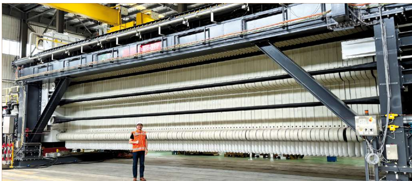
Собранный фильтр Larox® FFP3716 на заводе Metso — Сучжоу, Китай
