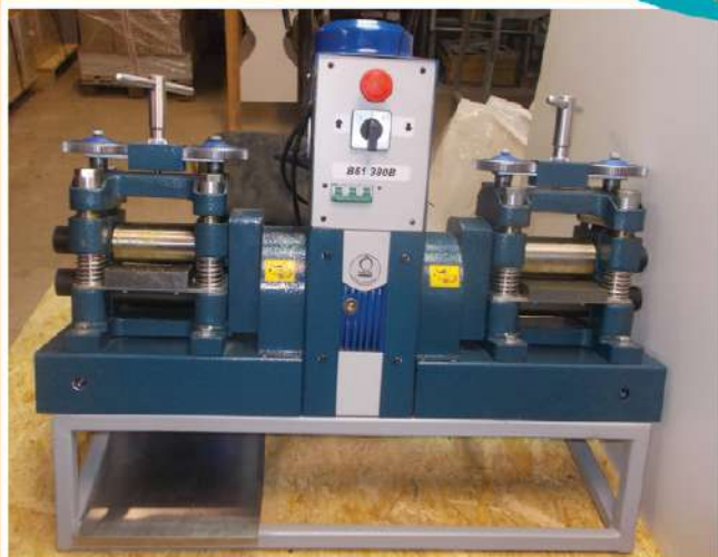
Вальцы двусторонние для многоручьевой прокатки корточек и свинцовой фольги
