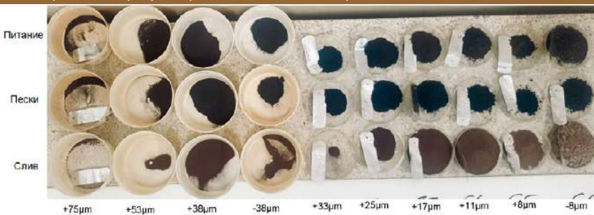
Рис. 3. Грансостав продуктов разделения в дешламаторе
