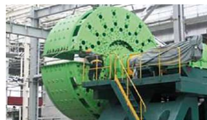
Рис. 7. Последовательность монтажных работ мельницы самоизмельчения с размером барабана 5.0x1.33м
