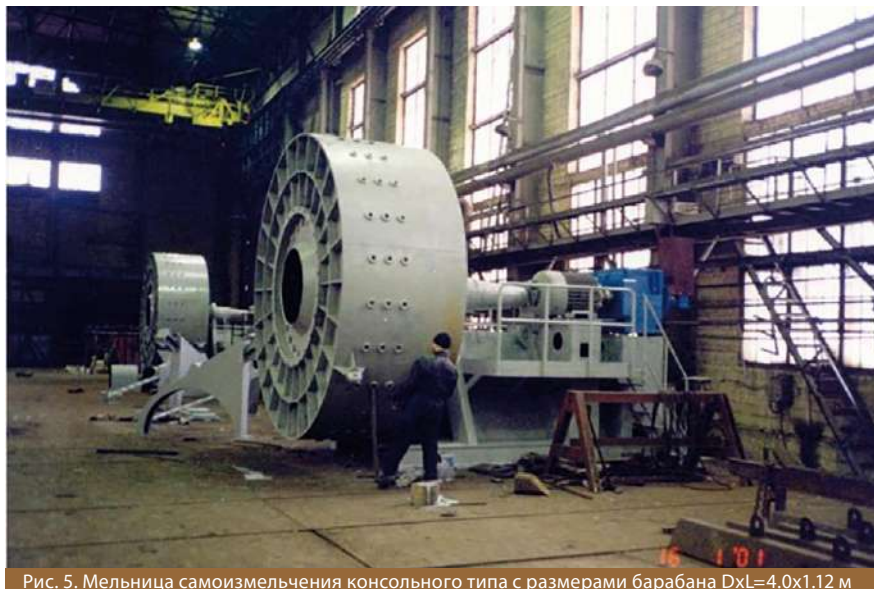
Рис. 5. Мельница самоизмельчения консольного типа с размерами барабана D \times L = 4,0 \times 1,12 м
