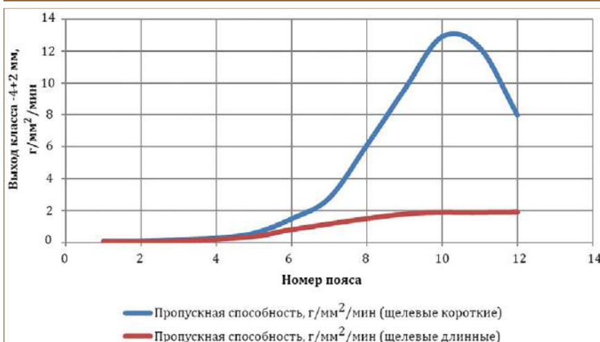
Рис. 4. График зависимости выхода класса -2+0 мм от протяженности щелевого отверстия
