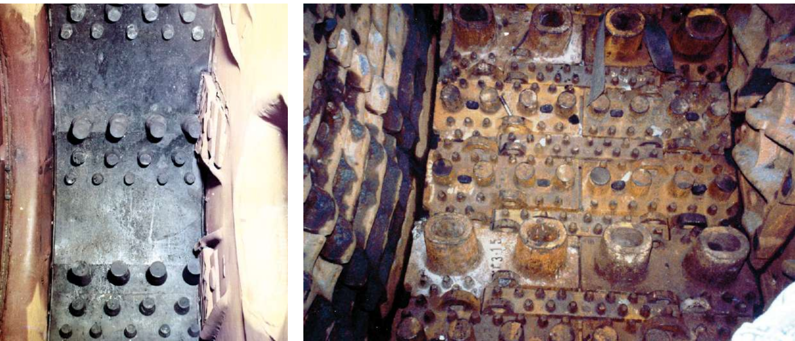
Рисунок 2. Испытание каблучковой футеровки на опытной мельнице D \times L = 2,1 \times 0,7 («Алроса») и на цементном заводе на мельнице D \times L = 7,0 \times 2,3 м
