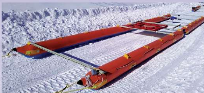
Томографический сканер в работе по разведочным профилям, V=10 км/час, глубина до 150 метров.
