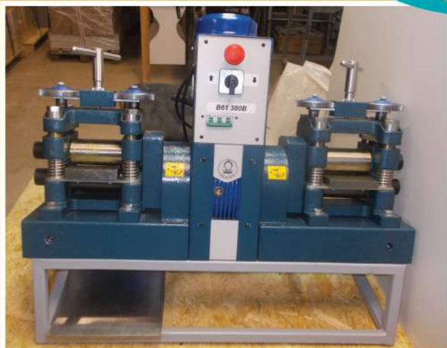
Вальцы двусторонние для многоручевой прокатки корточек и свинцовой фольги
